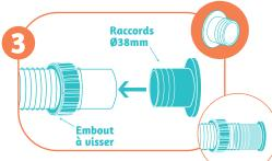
Emboitez complétement le connecteur Ø38mm dans le tuyau
